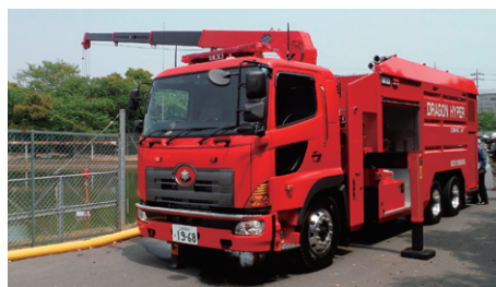
大容量送水ポンプ車による取水
